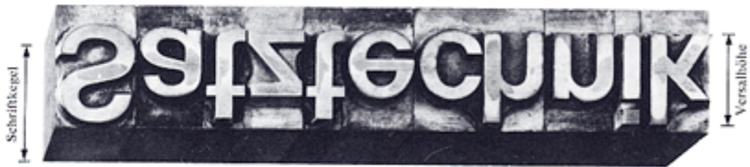
Abb. 13 Bleibuchstaben. Die Kegelstärke ist 5 Cicero, die Versalhöhe dem- gegenüber nur rund 4 Cicero.
